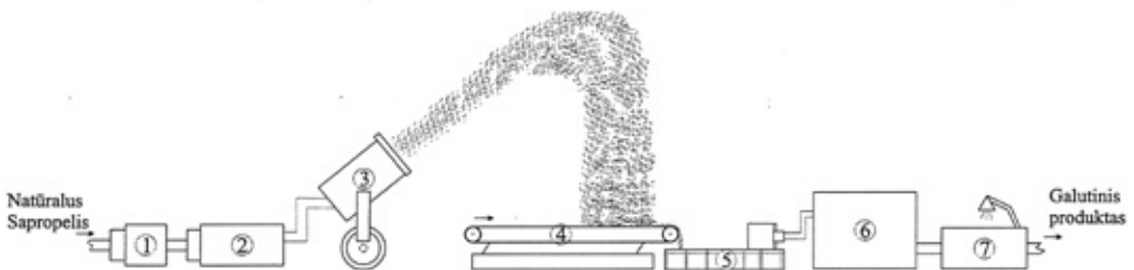
4 pav. Vandens šalinimo iš sapropelio prototipo mechanizmas
