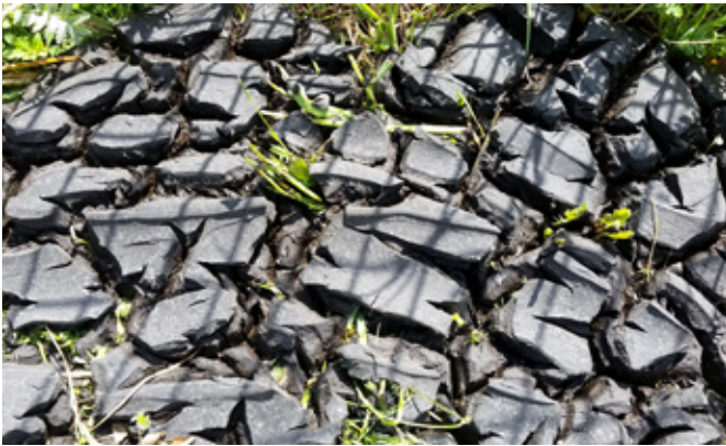
◀ 3 pav. Neperšaldytas ir natūraliai sudžiūvęs sapropelis, virtęs į keramiką
