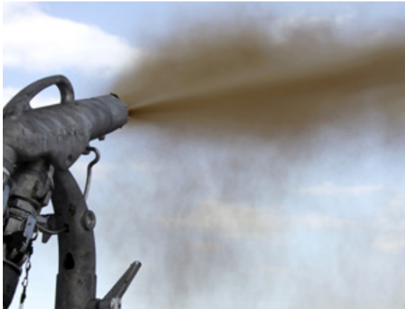
5 pav. Sapropelio išpūtimas taikant patentuotą prototipą
