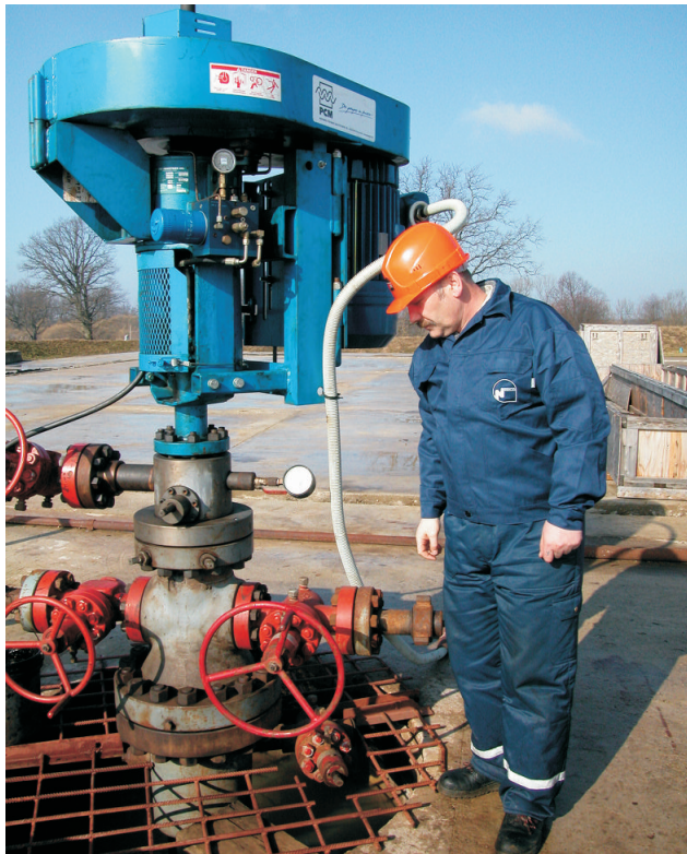
2 pav. Sraigtinio siurblio antžeminė dalis – gręž. Nausodis-10 (N.Steponavičiaus nuotr.).
