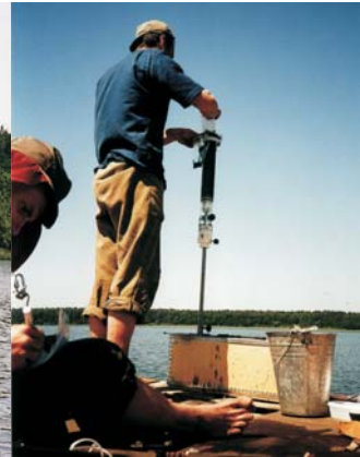
3 pav. Gravitacinio tipo stratometras paviršinio nuosėdų sluoksnio mėginimams paimti.
